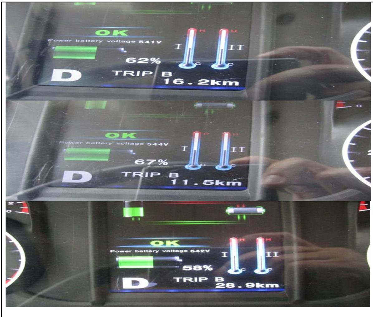
*Fotografía 9. Estado de carga de baterías en tablero*
