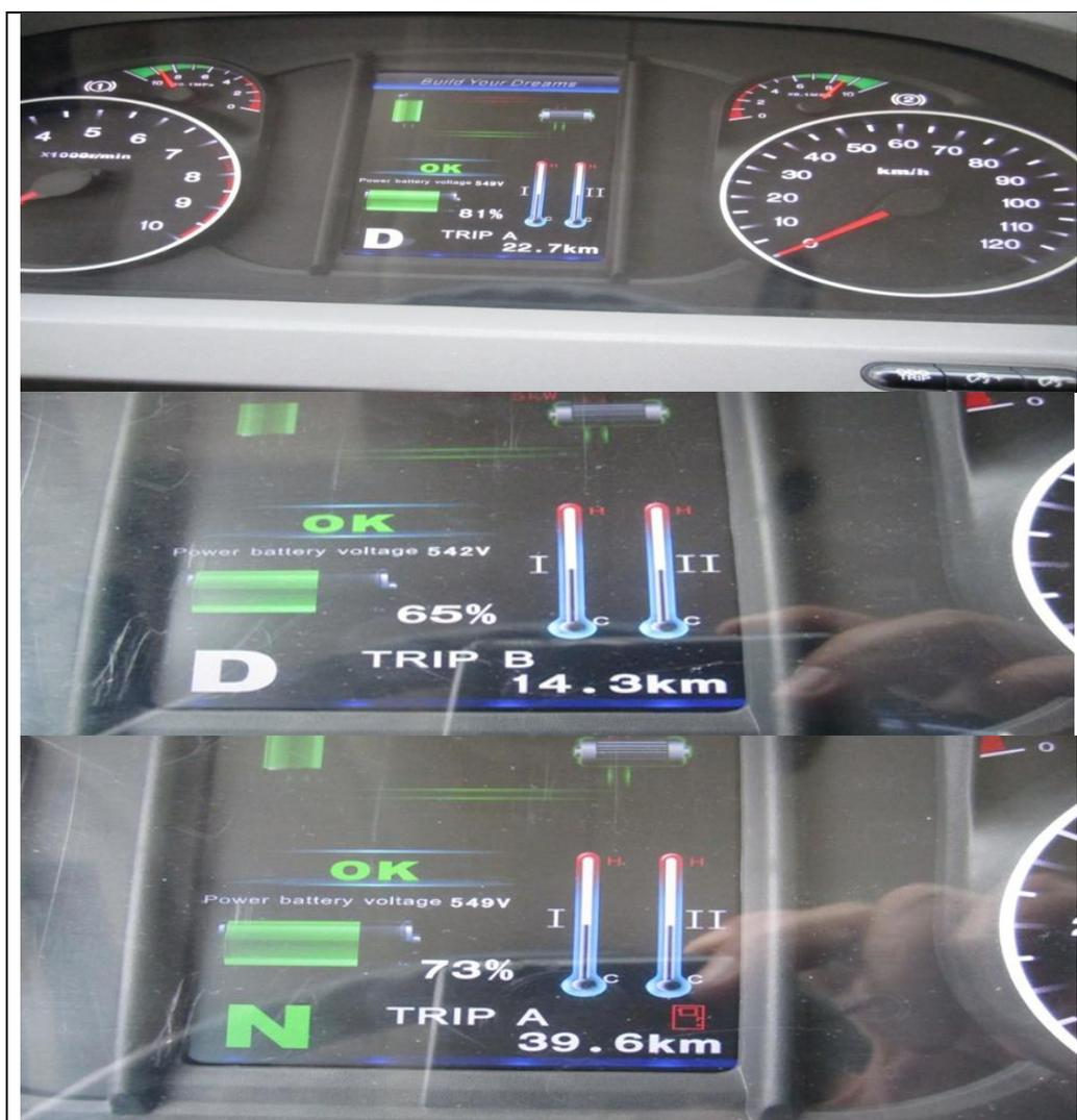
Fotografía 8. Estado de carga de baterías en tablero
