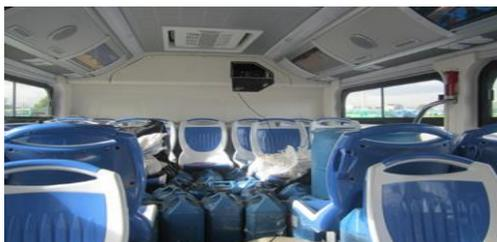
Fotografía 7. Carga simulada al interior del bus
