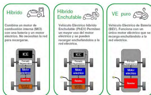
Figura 2. Esquema de los distintos tipos de vehículos eléctricos
