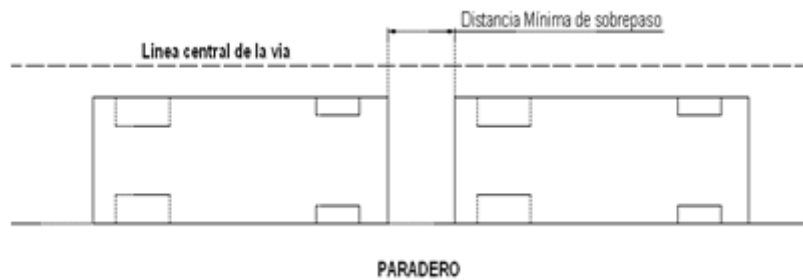
Figura 12. Esquema de la prueba de distancia mínima de sobrepaso.
