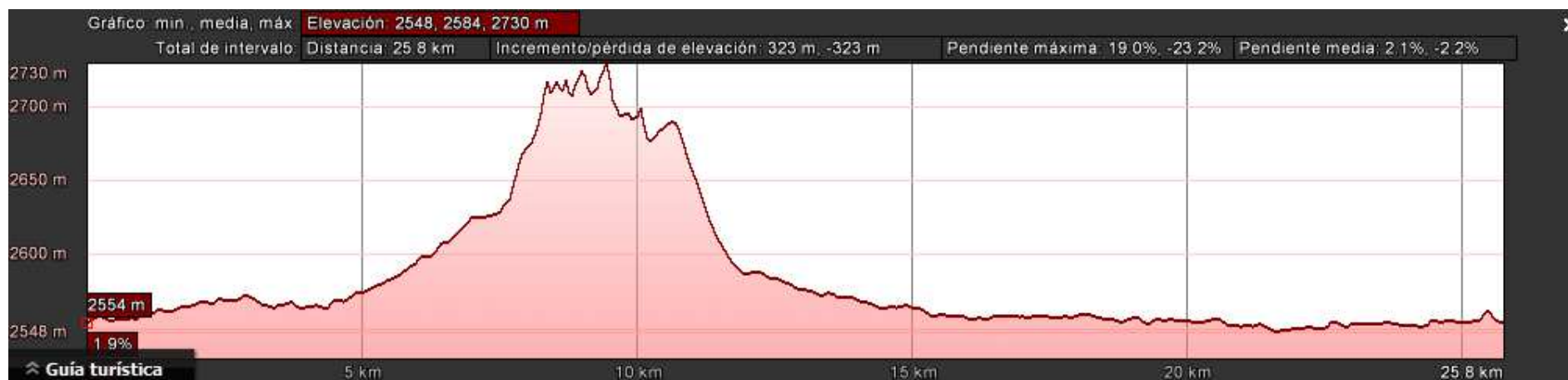
Figura 3 Perfil de elevación ruta bus PADRON para medición de emisiones
