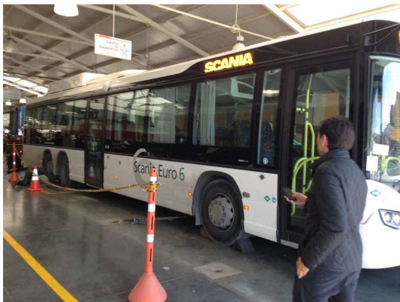
Figura 19. Montaje del vehículo en el banco dinamométrico.
