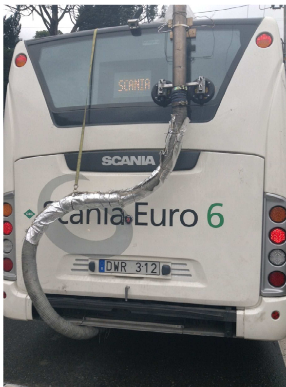
Figura 17. Sistema de muestreo de gases para la prueba de emisiones en ruta.
