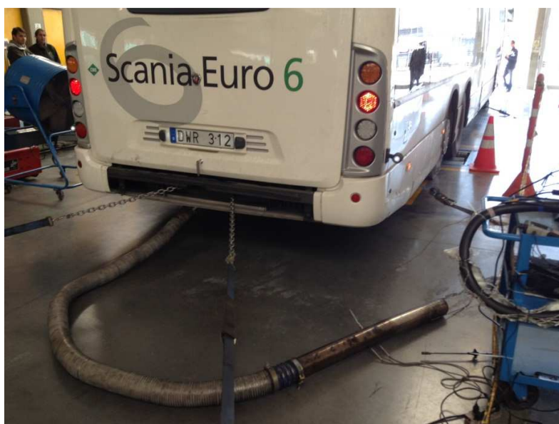
Figura 18. Montaje de equipos de medición de emisiones para la prueba en el banco dinamométrico.
