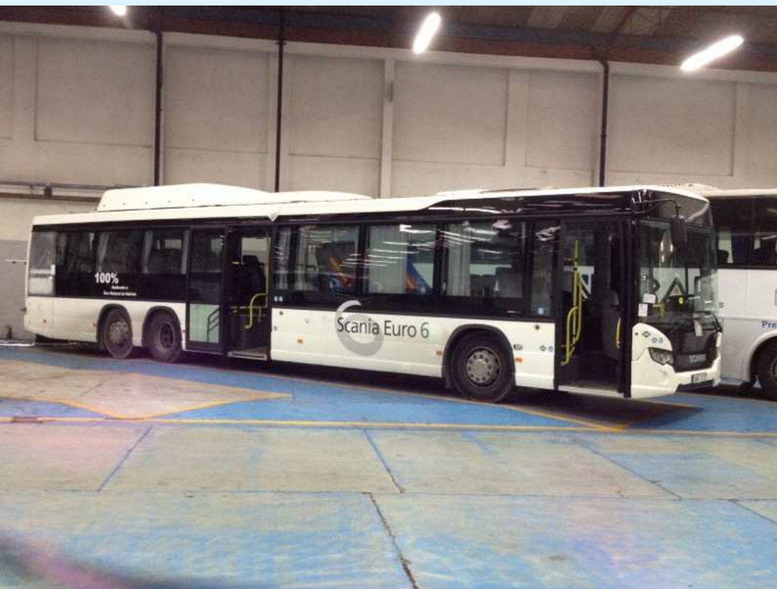
SCANIA REFERENCIA K340 – DEDICADO A GAS NATURAL MOTOR: OC09 102/250 kW (340 HP) Euro 6 - ESTEQUIOMETRICO
