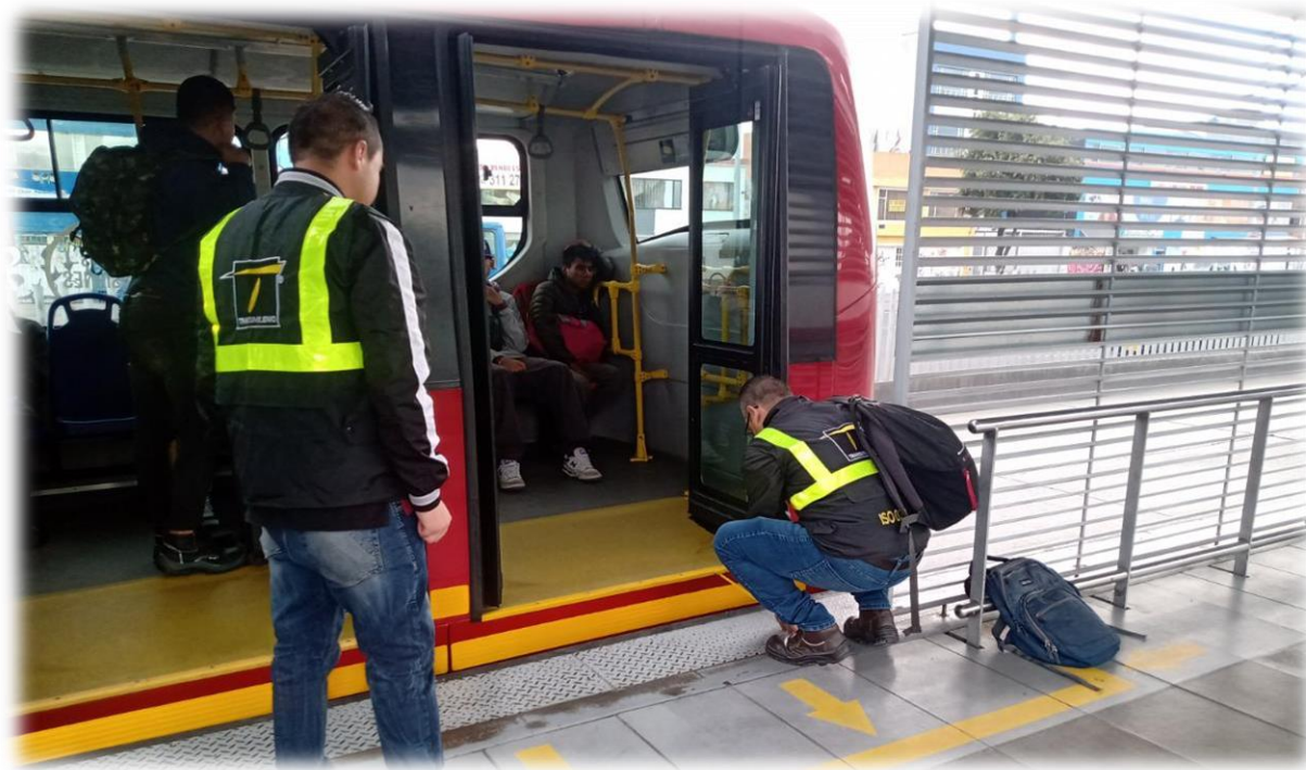
Verificación de distancia de seguridad entre plataforma y último vagón
