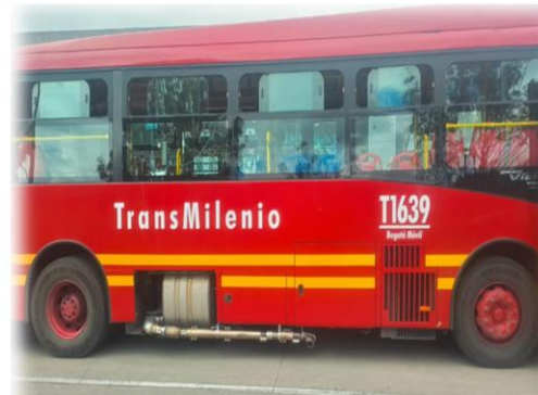
Instalación tubo toma muestra en exosto del bus biarticulado VOLVO - JTO 748
