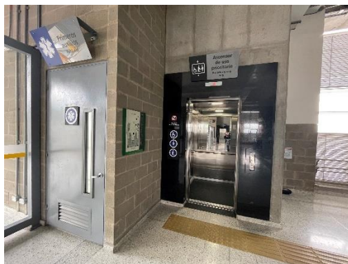
Señalización podotáctil en ascensores y taquillas del Cable
