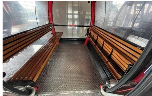
Interior de cabinas con bancas plegables
