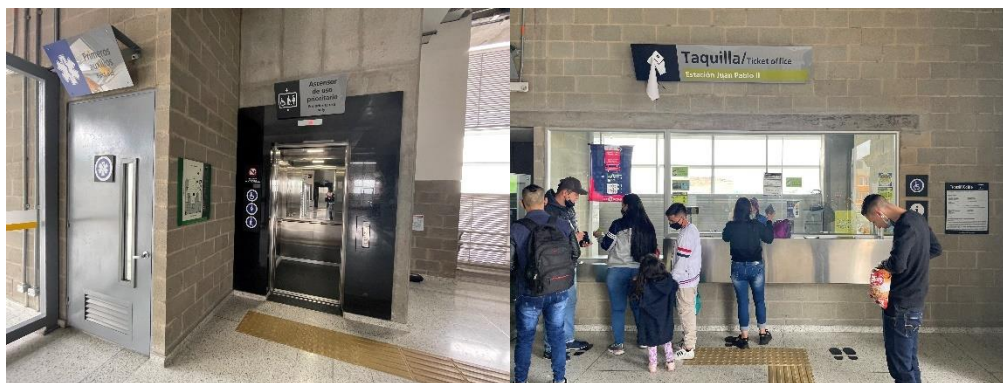
Señalización podotáctil en ascensores y taquillas del Cable
