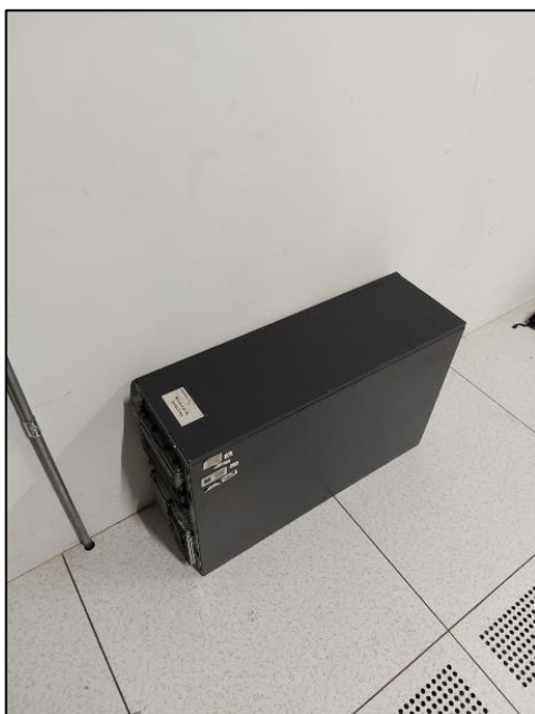
Gabinete con el rótulo: "Servidor de BD Operaciones" (inadecuada protección de los activos tecnológicos, posible pérdida de información, dificulta la libre circulación del personal)
