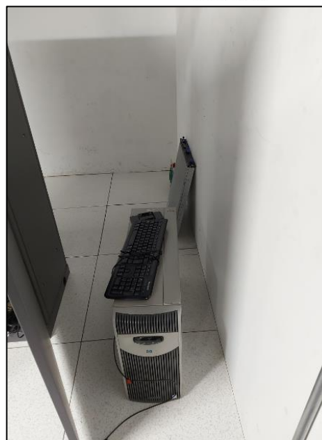
Gabinete de un computador, teclado de computador y gabinete tipo blade (inadecuada protección de los activos tecnológicos, posible pérdida de información, dificultan la libre circulación del personal)
