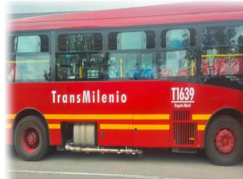
Instalación tubo toma muestra en exosto del bus biarticulado VOLVO - JTQ 748
