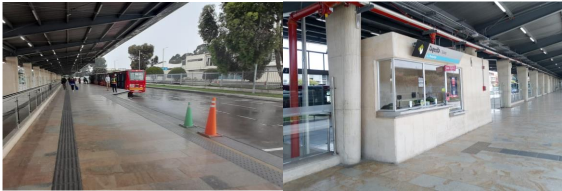
Señalización podotáctil guía en infraestructura nueva
