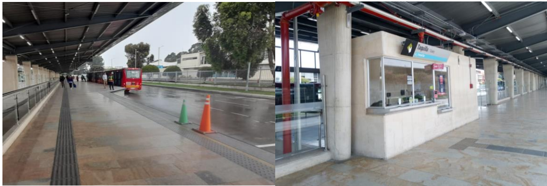
Señalización podotáctil guía en infraestructura nueva
